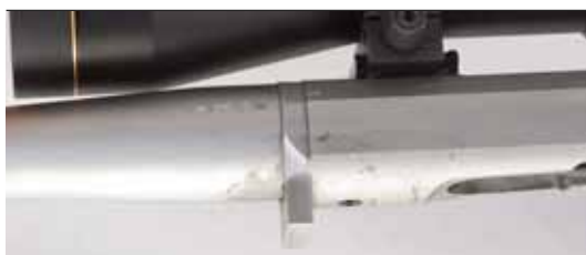
Rekyklacken är placerad mellan låda och pipa.
