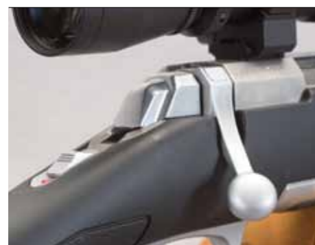
Säkringstangenten på kolvhalsen låser tändstift och slutstyckshandtag.
