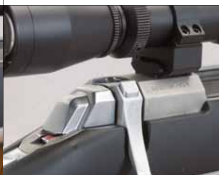
När tangenten trycks ner kan mekanismen plundras i säkrat läge.
